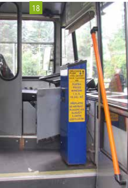
SROVNÁNÍ PRVKŮ SOUČASNÉHO ELEKTRONICKÉHO SAMOODBÁVNÍHO ODBAVOVÁNÍ CESTUJÍCÍCH (LCD TERMINÁL ŘIDIČE EPT 4.08B A VALIDÁTOR EVK 5.0 BP) S DŘÍVE POUŽÍVANOU POKLADNOU (VLEVO). FOTO ZDENĚK KRESA
