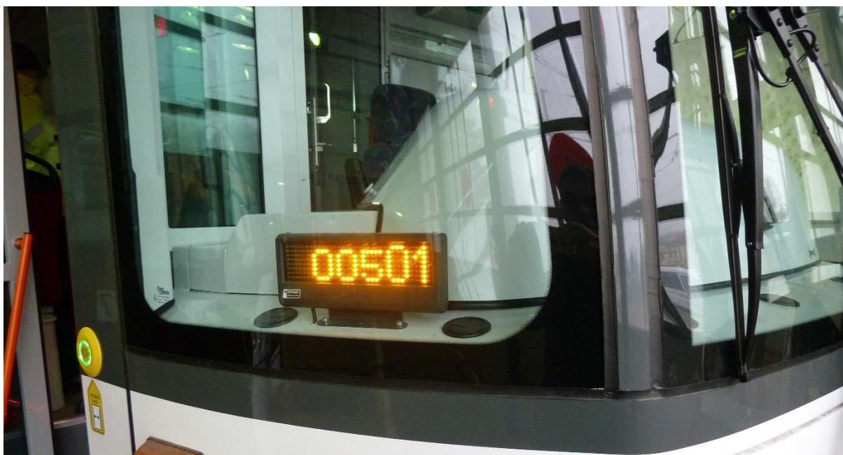
Obrázek 7: Nový typ ukazatele kurzu VLP 08x35.
