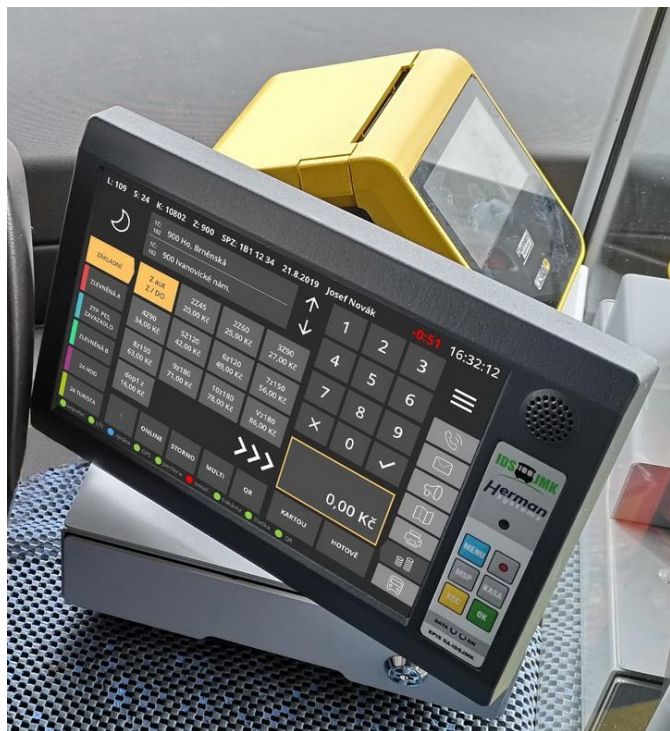
Obrázek 2: Palubní počítač s odbavením EPIS 5A-FCS včetně pokladny a odbavovacího terminálu EPP 5.0BK.
